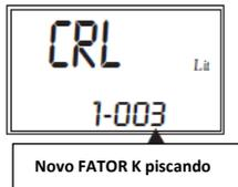
Após alguns segundos, o medidor sai automaticamente do modo de calibração e começa a usar o novo fator de calibração. Uma operação de calibração é suficiente para realizar a calibração precisa. Se você deseja verificar o resultado desta calibração, complete novamente o abastecimento no mesmo recipiente de calibração sem entrar novamente na função de calibração no menu Personalização.
