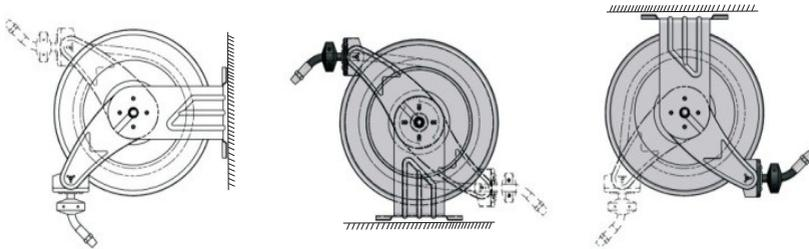
Dependendo de onde o carretel for colocado poderá ser necessário ajustar o batente da mangueira corretamente. Siga as instruções para ajustar o batente da mangueira e reposicionar o braço-guia:
