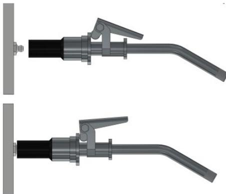
Após a lubrificação pressione novamente a alavanca para desacoplar o pino graxeiro.
